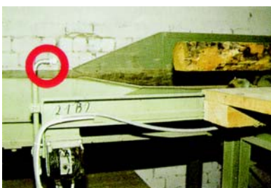
Telco-Lichtschranken an einem Transportband in einem Sägewerk
