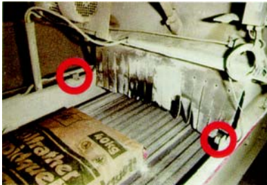
Telco-Lichtschranken in Zement- und Kalkwerken
