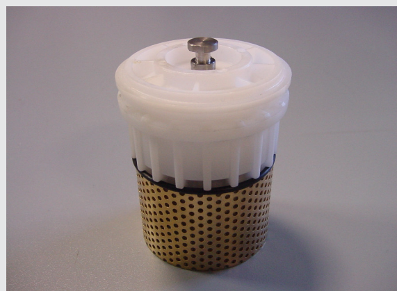
Schalldämpfer an Stellglied montiert
