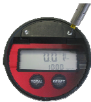
Illustration 1: Ôter le couvercle de la pile
