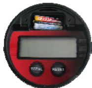
Illustration 2: Retirer la pile de son compartiment
