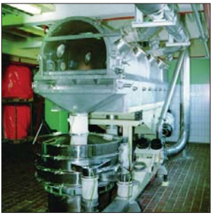
Bild 21: Vibrations-Fließbett-Trockner VF 40/10 in einer Nahrungsmittelfabrik
