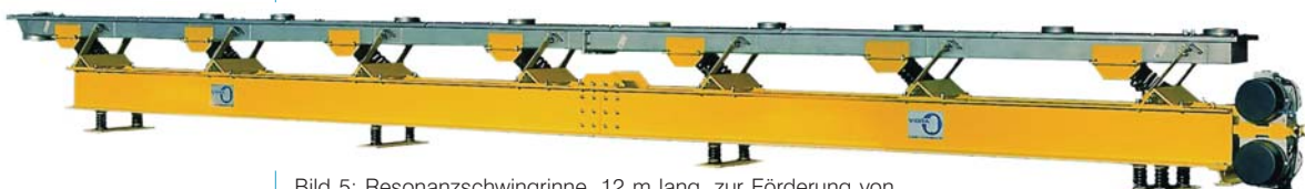
Bild 5: Resonanzschwingrinne, 12 m lang, zur Förderung von 10 t/h Waschmittel
