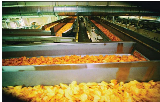
Bild 3: Teilansicht einer 120 m langen Resonanz-Schwingförderanlage für 60 m 3 /h Kartoffelchips zur Beschickung von Verpackungsmaschinen
