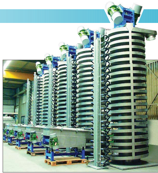
Bild 26: Kühlwendelförderer 1400 mm Durchmesser mit vorgeschalteten Siebmaschinen für die Absiebung und Kühlung von je 3000 kg/h Kunststoffgranulat
