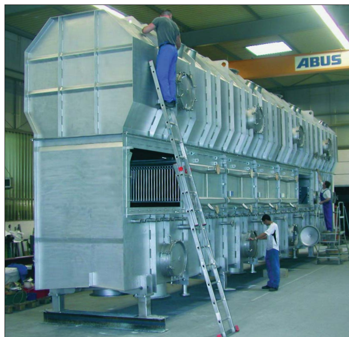
Bild 28: Wirbelschichttrockner, Anströmfläche 26 m 2 , mit eingebauten Wärmetauschereinschüben für ein Waschmittelvorprodukt
