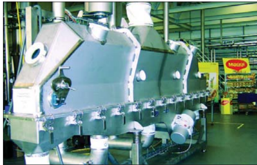
Bild 23: Vibrations-Fließbett-Trockner VF 40/ 3,5 in einem Entwicklungszentrum
