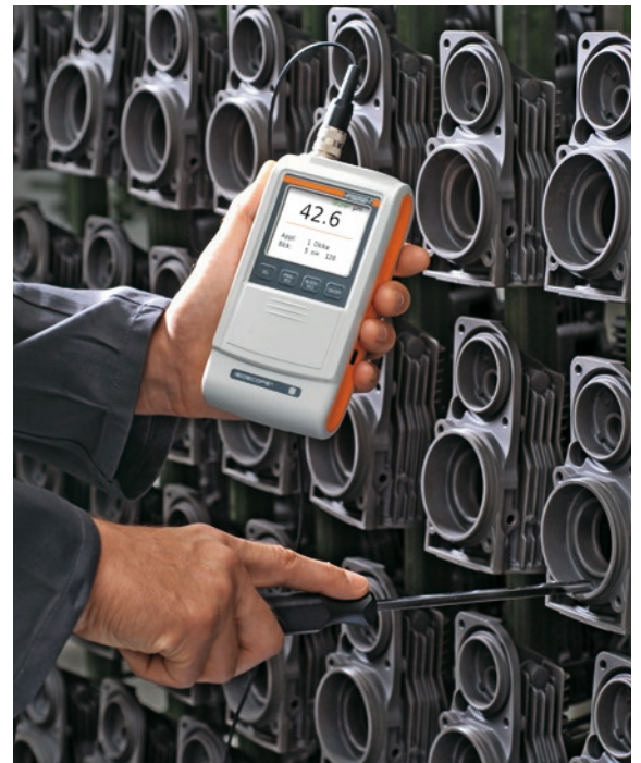
Messung mit der Innenmesssonde FAI 3.3-150
