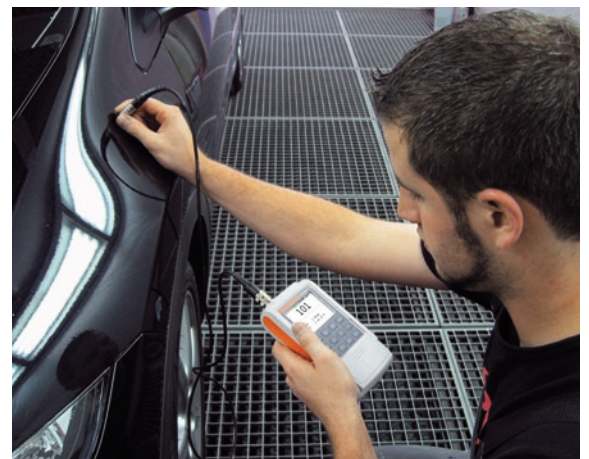
Lackschichtdickenmessung mit der Dual-Sonde FD13H
