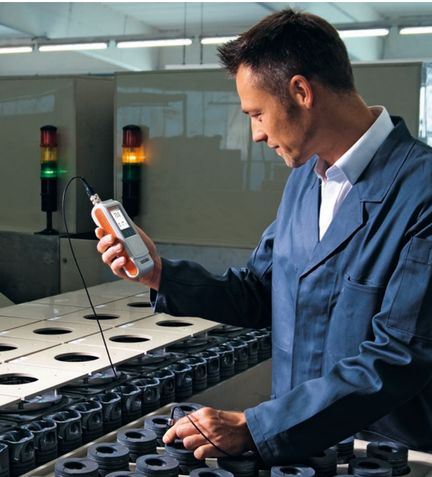
Qualitätsüberwachung an Motorkolben direkt nach dem Fertigungsprozess mit der Sonde FTA3.3H
